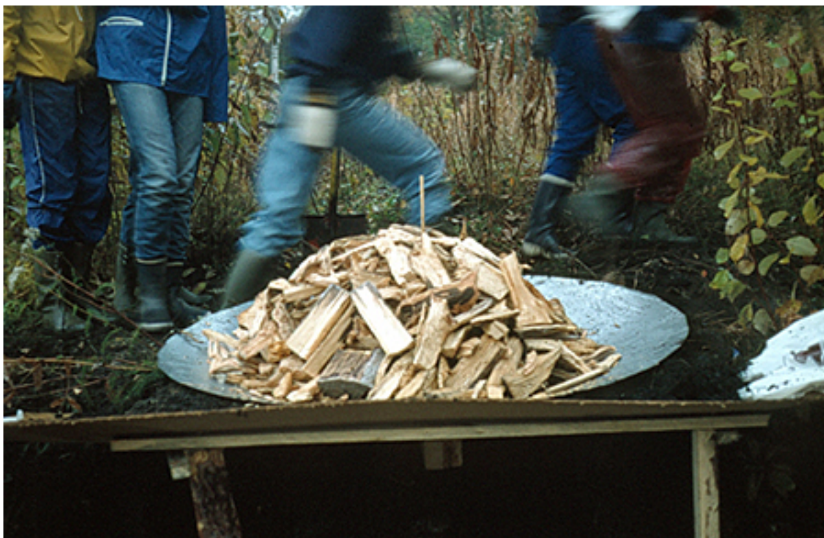
Bild 36. Inläggningen fortsätter. Pinnen som sticker upp täpper till tapphålet vid skon så att inte skräp ska täppa till hålet. Pinnen tas bort innan spinkveden läggs på. Foto. Fredrik Westman.
