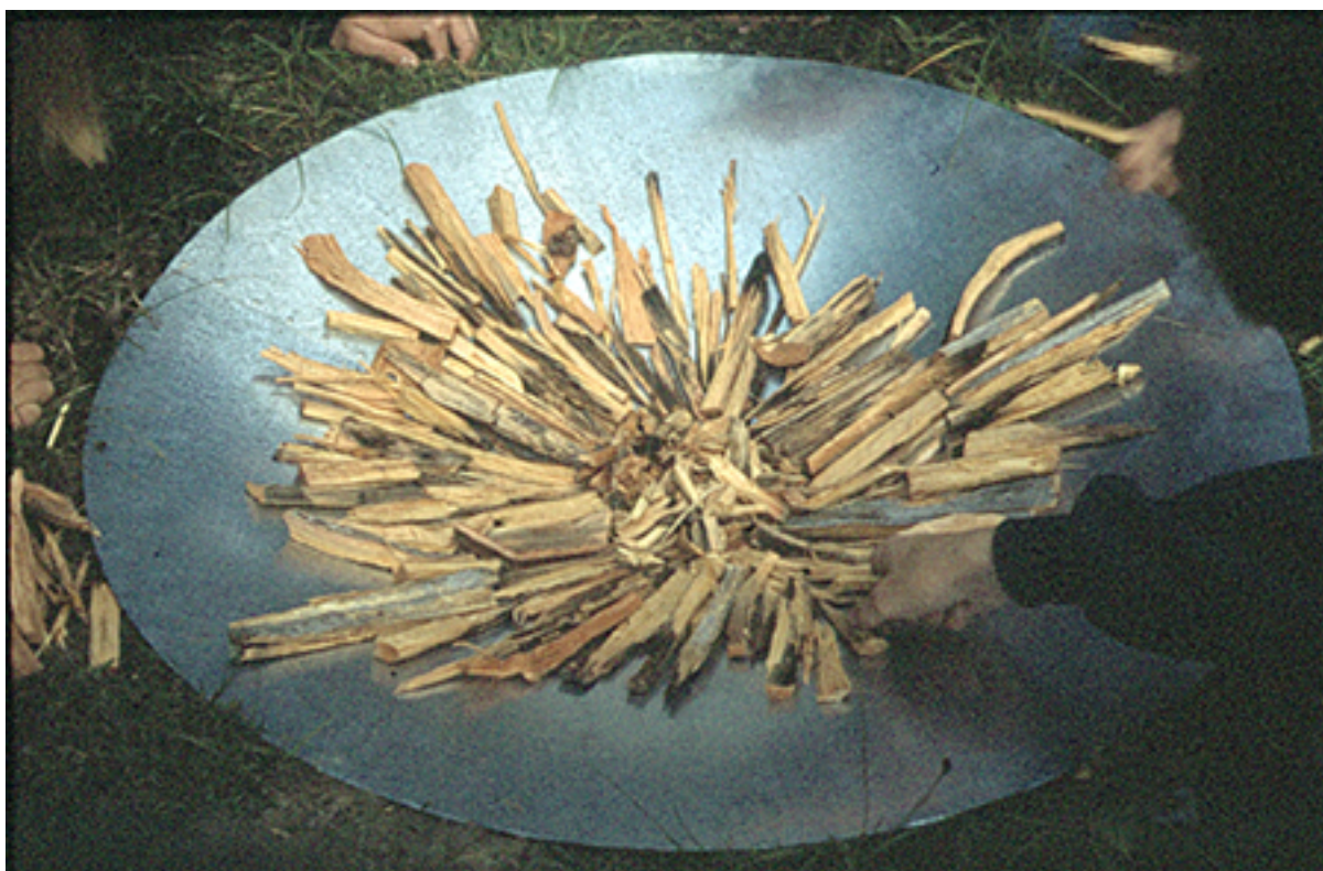
Bild 35. Tjärveden läggs in solfjäderformigt med fet småved i centrum. En plåtkon med ett tapphål i konens spets användes i stället för takspån för att göra underredet lufttätt. Foto. Fredrik Westman.
