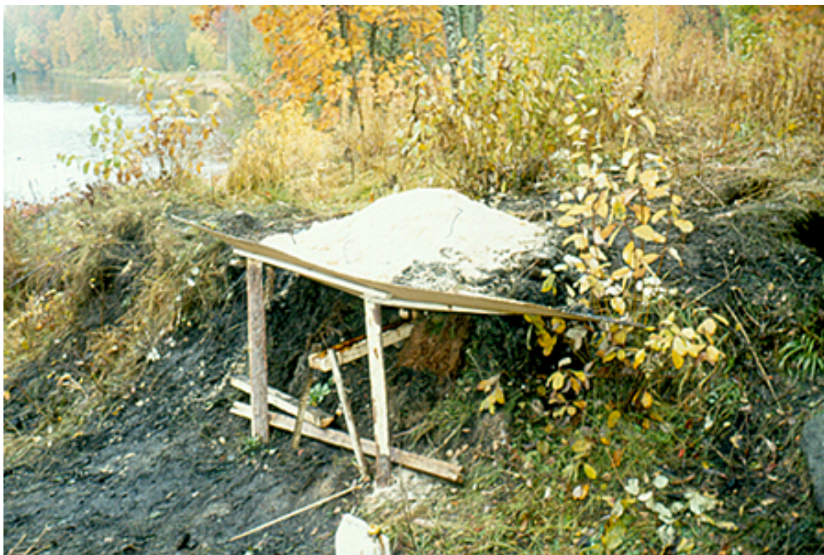
Bild 42. Kolastöten. Minitjärdalen täcks med jord, med blöt sågspån ovanpå jorden. Efter 3 dagar har minitjärdalen svalnat och är det dags att ta bort jorden och sågspånen. Dalkolen som bildats användes sedan av eleverna i en minismedja. Foto. Fredrik Westman.
