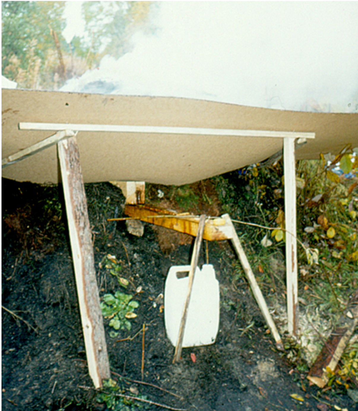
Bild 41. Ca 45 minuter efter tändningen kommer tjäran. Efter ca 3 timmar är bränningen klar. Foto. Fredrik Westman.
