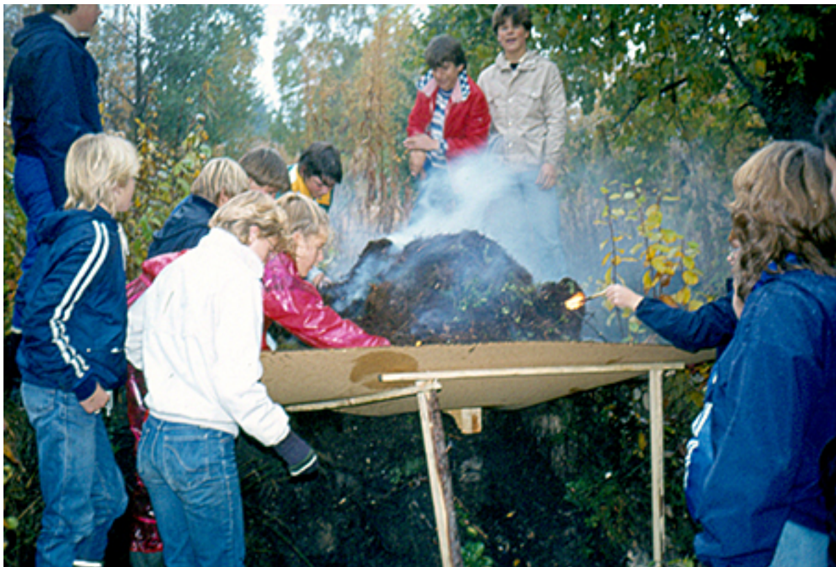
Bild 38. Tjärveden är nu täckt med torv. Längst upp finns ett rökhål så att elden ska söka sig uppåt då man tänder nere vid eldskottet. Foto. Fredrik Westman.
